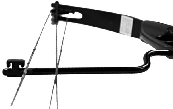
Als nächstes wird der Kabelgleiter an den Kabeln angebracht.
