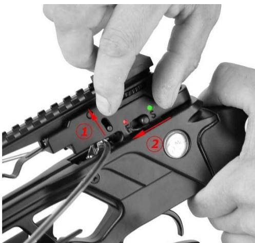
Mit dem linken Zeigefinger bewegen Sie die Anti-Dry-Fire Sicherung (Leerschusssicherung) (1) von BOTTOM auf TOP. Gleichzeitig schieben Sie mit ihrem linken Daumen die Abzugssicherung von SAFE (grüner Punkt) auf FIRE (roter Punkt) (2).
