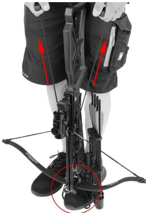
Ziehen Sie beide T-Griffe gleichzeitig nach oben, bis die Sehne in die dafür vorgesehene Halterung am Abzugsmechanismus einrastet. Ziehen Sie die Sehne ganz nach hinten, bis die Abzugssicherung in die SAFE Position springt. Lösen Sie die Griffe der Spannhilfe langsam, um sicher zu gehen, dass die Abzugsverriegelung die Sehne wirklich aufgenommen hat. Jetzt ist die Armbrust komplett gespannt und bereit zum Laden. Entfernen Sie nun die Sehnenspannhilfe.
