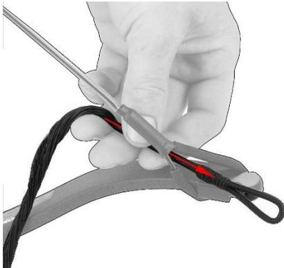
Legen Sie nun die Sehne mit den Schlaufen auf jedes Wurfarmende durch / unter die Schlaufe der Montagehilfe.
