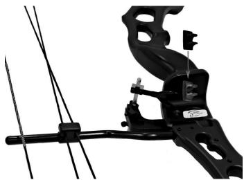
Die Pfeilauflage ist mit einem Seil versehen, welches an einem der Kabel, oder an beiden Kabeln angeknotet wird. Wird der Bogen ausgezogen, stellt sich die Pfeilauflage in Abschussposition auf. Beim Schuss klappt sie nach unten weg und gibt den Pfeil frei.
